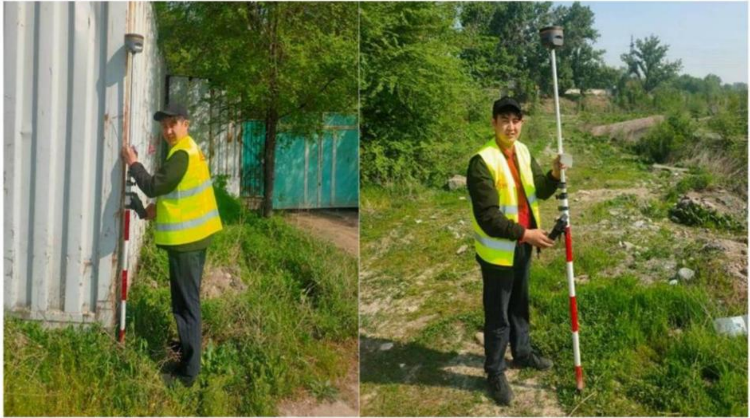
4.1 Сурет - South Galaxy G қабылдағышымен топографиялық түсірістің жүру барысы
